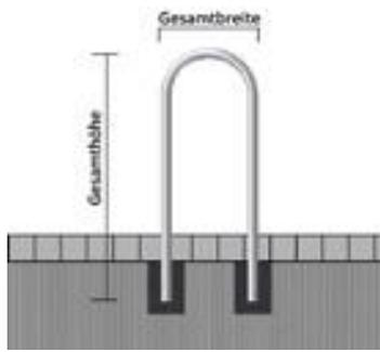
**zum Einbetonieren**, Stahlrohr  $\varnothing$  48 mm,
