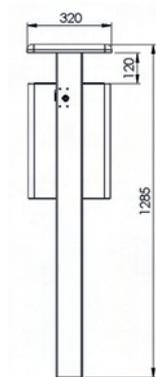
Seitenansicht zum Einbetonieren
