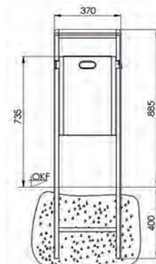
Frontansicht zum Einbetonieren
