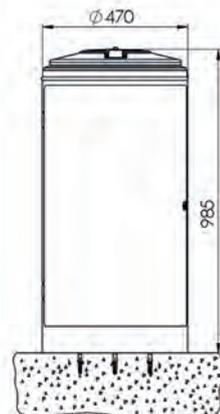
Montage auf Betonfundament
