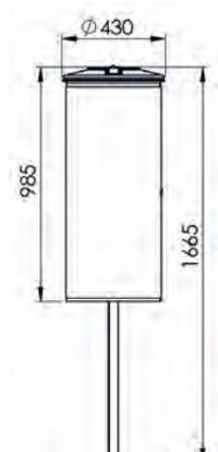
Vorderansicht 8059-01 zum Einbetonieren
