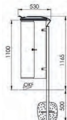
Seitenansicht 8059-01 zum Einbetonieren
